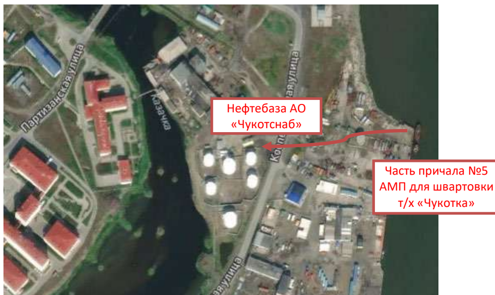
Рис. 2.3 Схема выгрузки светлых нефтепродуктов на нефтебазу АО «Чукотснаб» с причала №5 АМП в г. Анадырь
